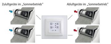
Ein Ventilator der **AIRUNIT** GEMINI arbeitet in dieser Einstellung konstant im Zuluftbetrieb und der andere Ventilator konstant im Abluftbetrieb. Eine Wärmerückgewinnung findet nicht statt. Nach 8 Stunden wird automatisch in den Winterbetrieb mit Wärmerückgewinnung gewechselt.
