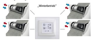
Die Ventilatoren der AIRUNIT GEMINI Lüftungseinheit(en) arbeit(en) gegenläufig in 2 einjustierten Zeitintervallen. Die Funktion der Wärmerückgewinnung wird anhand eines Ventilators dargestellt. Im ersten Intervall (Abluftphase) wird die "verbrauchte" Raumluft über die Lüftungseinheit nach außen abgeführt. Die Luft durchströmt dabei den Keramik-Wärmespeicher, der die Wärme der Raumluft aufnimmt und speichert.
